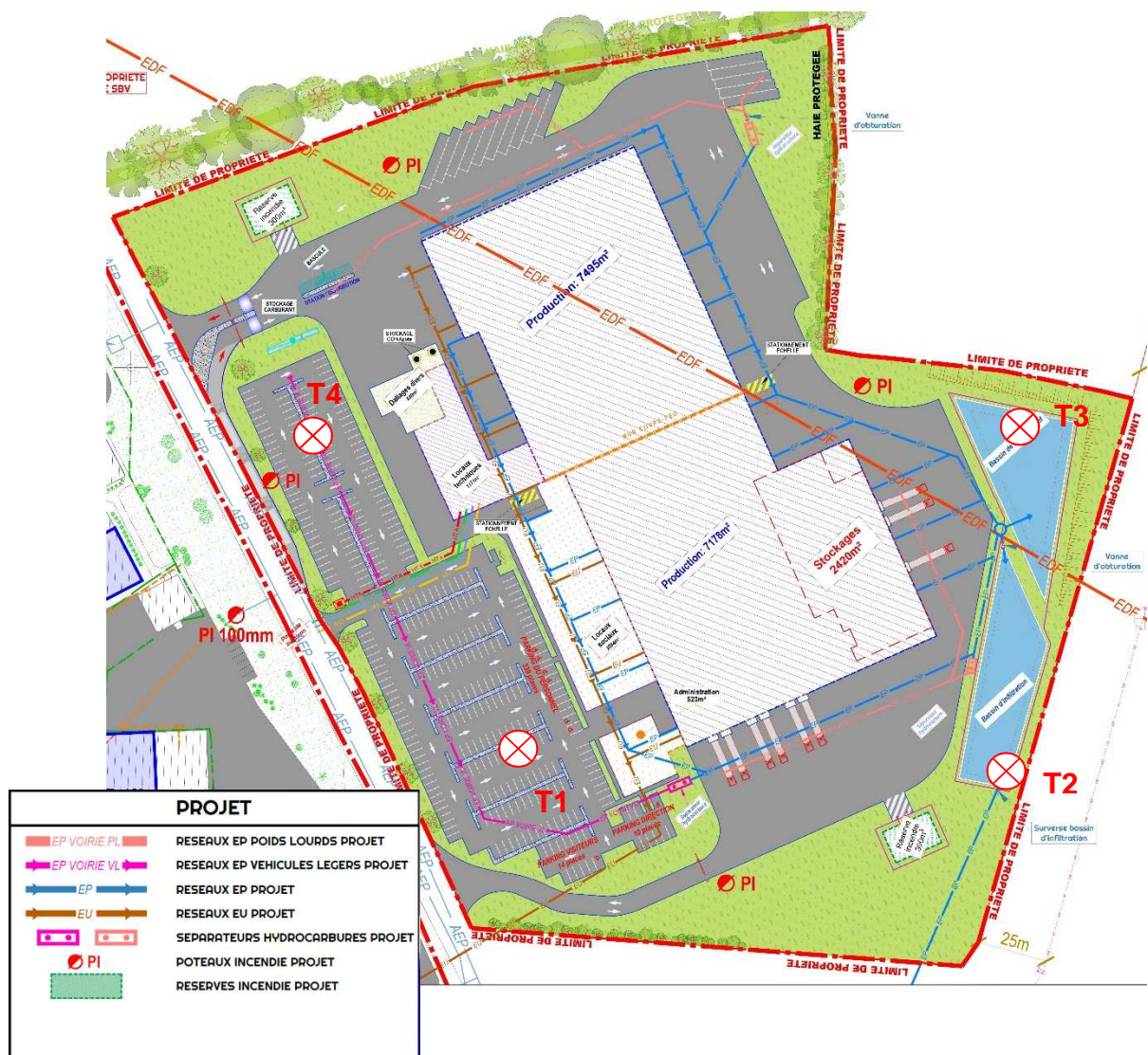
Figure 44. Localisation des tests d'infiltration
