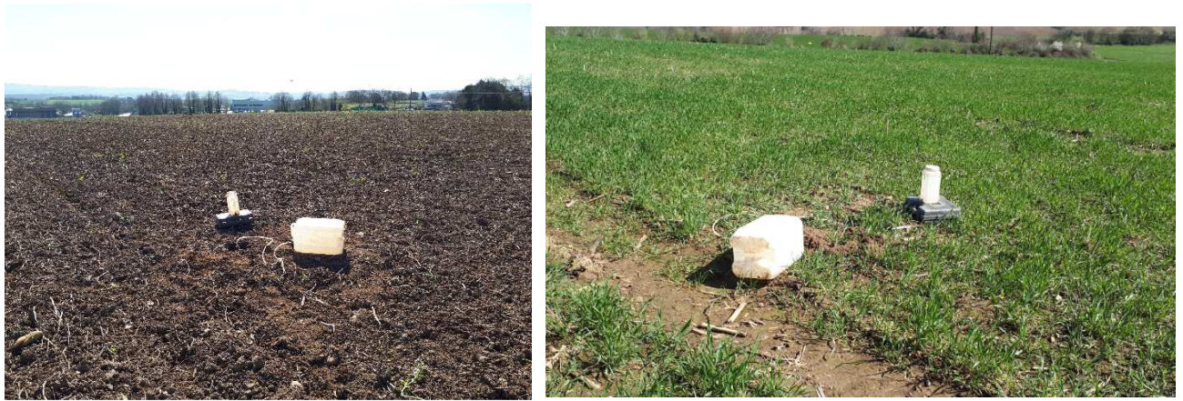
Figure 43. 2 des 4 tests d'infiltration réalisés sur le site le 27/03/19
